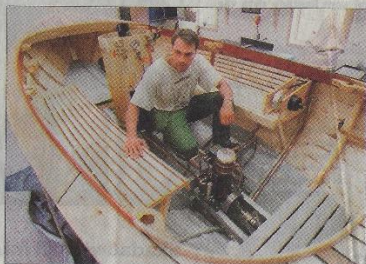
Ångslupen som tagit hela vintern att färdigställa av björk, furu och asp i spantet, ska snart i sjön för att köras efter älven i Umeå. Torbjörn Holst är nöjd med sitt verk, men åtar sig troligen inget lika stort projekt i framtiden. Det här är ett specialbygge.
